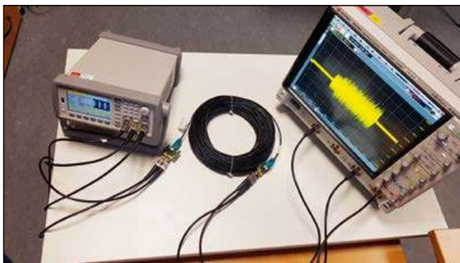
Abbildung 5: Signalgenerator und Oszilloskop angeschlossen an 100 Meter Zweidrahtleitung
